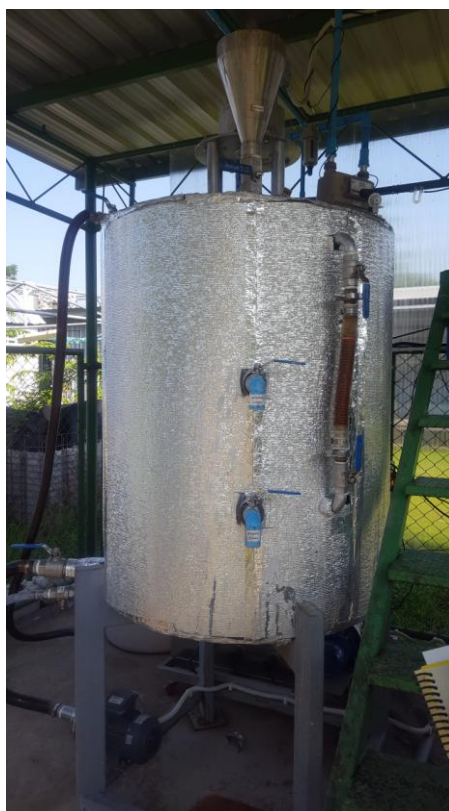
รูปที่ 4-9 ระบบถังหมักแบบ Continuous stirred-tank reactor (CSTR)
