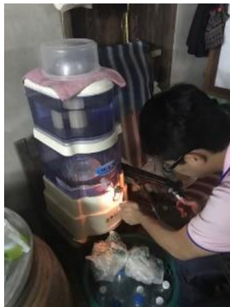
รูปที่ 8 การเก็บตัวอย่างน้ำอุปโภคสำหรับการตรวจวิเคราะห์เชื้อด้วยการใช้ชุดทดสอบ Petrifilm TM และ ตัวอย่างการเกิดโคโลนี (Colony) บนแผ่นเมมเบรนหลังจากการบ่มที่อุณหภูมิ 35 องศาเซลเซียส เป็นระยะเวลา 24–48 ชั่วโมง
