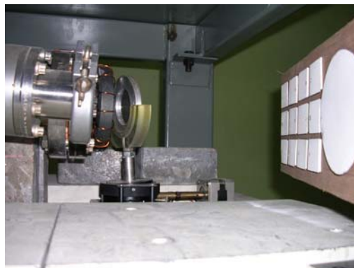
ภาพประกอบที่ 2.6.3 สถานีทดลองผลิตรังสีรังสีเอกซ์ที่ติดตั้งเรียบร้อยแล้ว (ในภาพไม่ได้แสดงส่วนของหัววัด)
