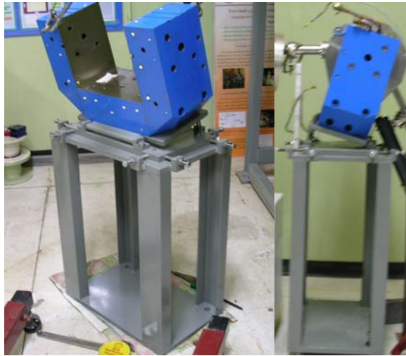
ภาพประกอบที่ 2.4.10 แสดง support ของแม่เหล็กสองขั้ว ซึ่งเอียงแม่เหล็กเป็นมุม 15^\circ
