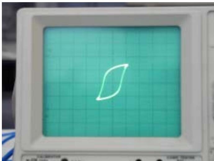
รูป 2.16 แสดงลักษณะของวงวนฮีสเทอรีซิสบนหน้าจอออสซิลโลสโคป
