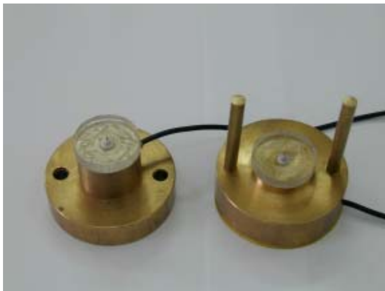
รูป 2.10 แสดงลักษณะภายในเครื่องมืออัดแรงแบบแกนเดียว (uniaxial stress compressometer)
