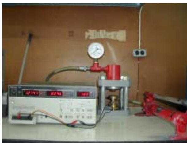
รูป 2.18 แสดงอุปกรณ์ที่ใช้วัดค่า \epsilon_r และ \tan \delta ที่สภาวะความเค้นสูง
