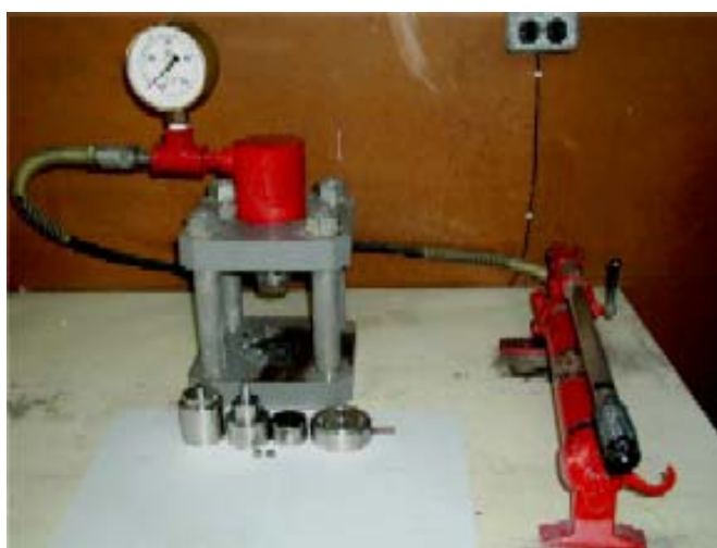
รูป 2.5 แม่พิมพ์โลหะและเครื่องอัดระบบไฮดรอลิกใช้สำหรับการอัดขึ้นรูป
