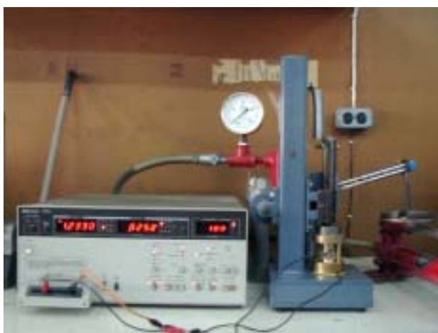
รูป 2.17 แสดงอุปกรณ์ที่ใช้วัดค่า \epsilon_r และ \tan \delta ที่สภาวะความเค้นต่ำ
