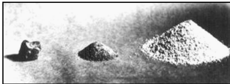
ภาพ 1.3 การขยายตัวของหินเพอร์ไลต์น้ำหนักเท่ากันเมื่อถูกเผาที่อุณหภูมิต่างๆกัน[15]
