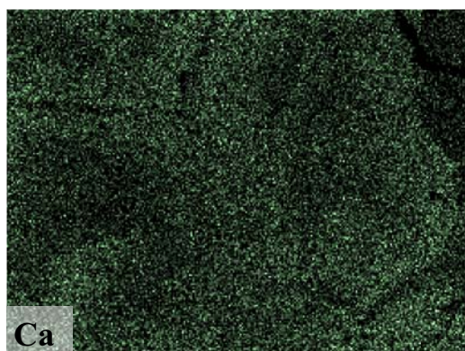
รูปที่ 5-2 ผลวิเคราะห์ SEM ของตัวอย่างหิน TrBr 31 ในตำแหน่งที่ 2 จำแนกแร่ได้ 2 phases ได้แก่ P1 (diopsidic clinopyroxene) และ P9 (2 nd material) [มาตราส่วน = 0.2 มม.]
