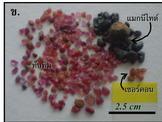
รูปที่ 1 ก. ลักษณะหน้าตัดชั้นหินบะซอลต์ให้พลอย วางตัวปิดทับชั้นตะกอนยุคใหม่ บริเวณบ้านหมื่นด่าน-บ้านคลองโสน ต. บ่อพลอย อ. บ่อไร่ จ. ตราด ลักษณะทับทิม (เจดสีชมพู-แดง) และแร่เพื่อนพลอย ที่พบสะสมตัวในชั้น กรวดใต้ชั้นบะซอลต์ดังกล่าว
