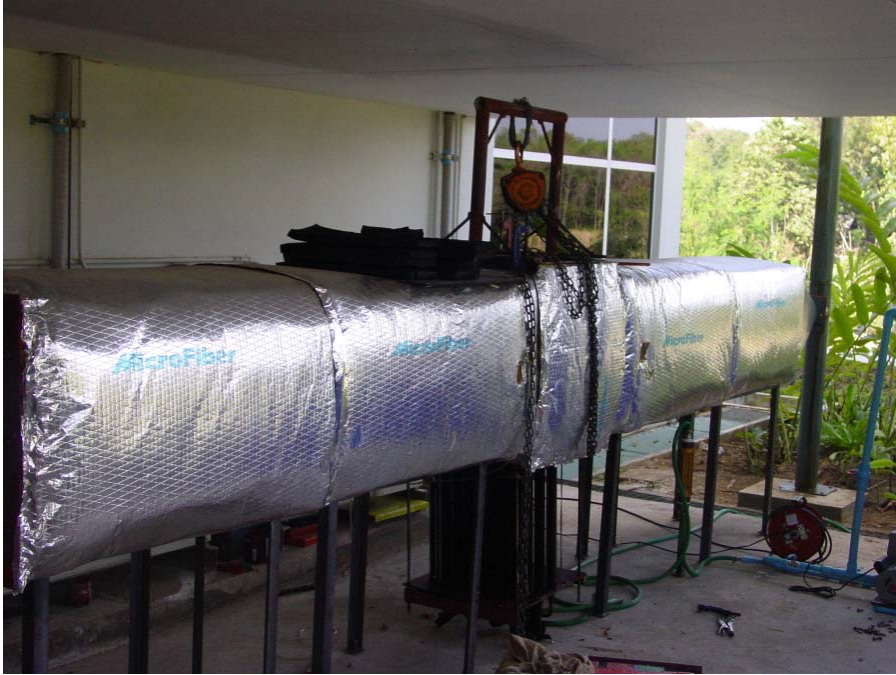
รูปที่ 2.2 อุโมงค์ลมทดสอบเครื่องแลกเปลี่ยนความร้อนแบบไหลตามขวาง
