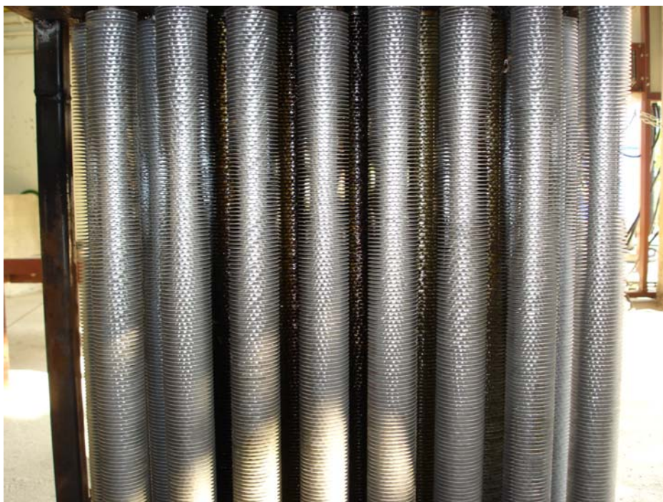
รูปที่ 2.6 ลักษณะของกลุ่มท่อที่นำไปติดตั้งในอุโมงค์ลมเพื่อทดสอบสมรรถนะในกรณีที่มีฝุ่น เข้ามาจากการเผาไหม้
