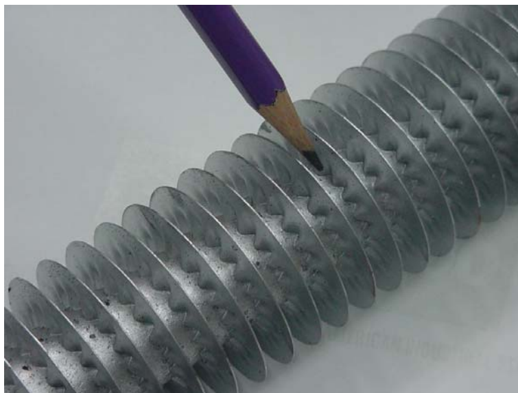
รูปที่ 1.3 ลักษณะของ Spiral Finned Tube ที่ใช้ในเครื่องแลกเปลี่ยนความร้อน
