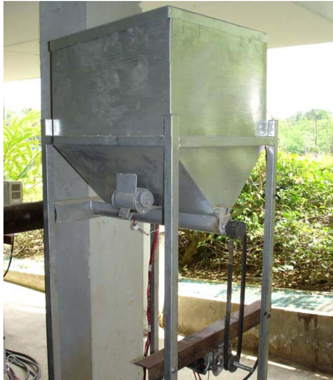
รูปที่ 3.2 เครื่องป้อนถั่วลอยเข้าสู่อุโมงค์ลม
