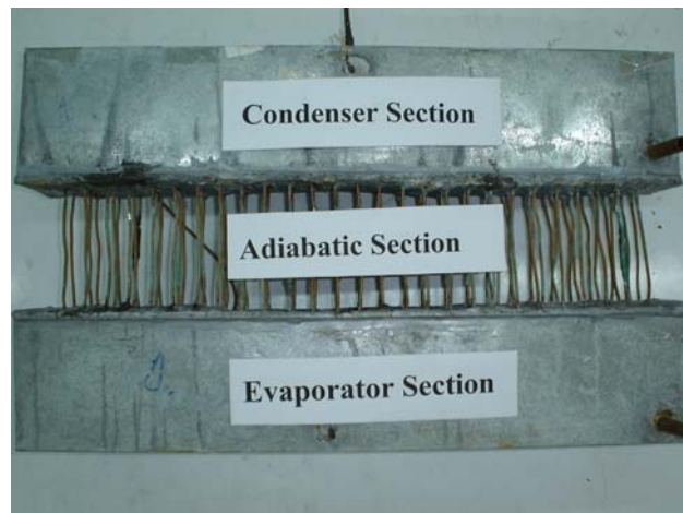
ภาพประกอบ 5 ท่อความร้อนแบบ CLOHP/CV ที่ติดกล่องทำเย็น และ กล่องทำร้อน
