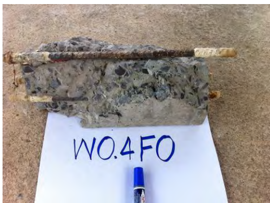
รูปที่ 3.10 ลักษณะเหล็กเสริมที่เกิดสนิมจากการทดสอบชนิดที่ใช้เหล็กเคลือบฟอสเฟต
