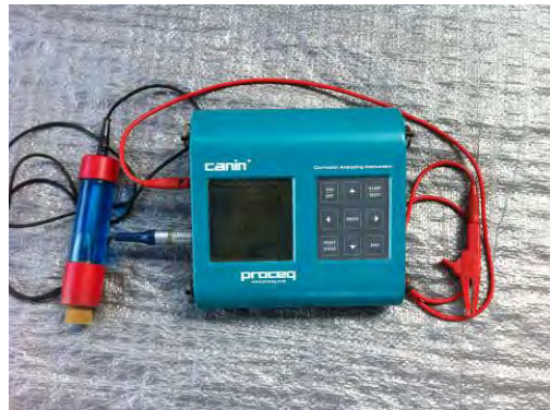
รูปที่ 2.15 เครื่อง Half-Cell Potential ใช้ทดสอบการเกิดสนิมของเหล็กเสริม
