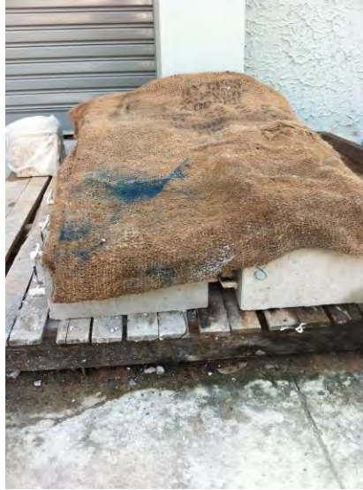
รูปที่ 2.10 การบ่มโดยใช้กระสอบที่ชุ่มด้วยน้ำคลุมที่ตัวอย่างคอนกรีต
