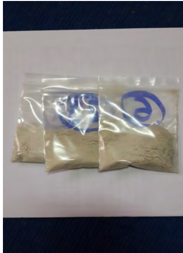
รูปที่ 2.16 ผงคอนกรีตที่นำมาไตรเตรชั่นเพื่อหาปริมาณคลอไรด์
