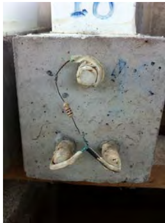
รูปที่ 2.11 การเชื่อมต่อตัวต้านทานขนาด 100 โอห์ม เข้ากับสายไฟที่ต่อกับเหล็กเสริม
