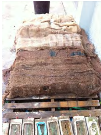
รูปที่ 2.12 การบ่มตัวอย่างคอนกรีตโดยใช้กระสอบที่ชุ่มด้วยความชื้นคลุม
