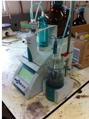
รูปที่ 2.17 การหาปริมาณคลอไรด์วิกฤติโดยวิธีไตรเตรชั่น
