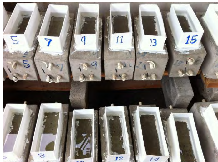
รูปที่ 2.13 การขังสารละลายโซเดียมคลอไรด์เข้มข้น 10 %
