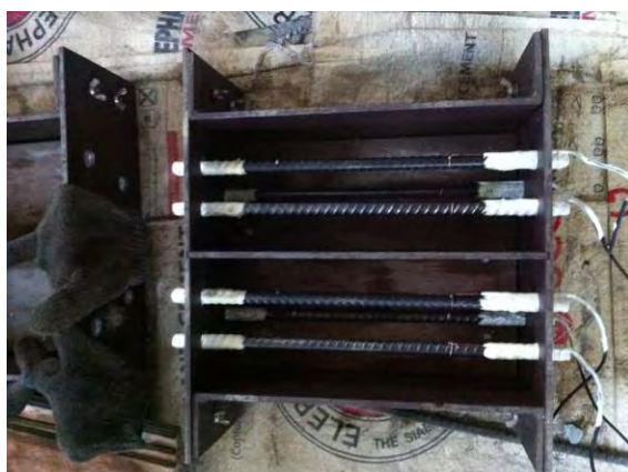
รูปที่ 2.8 การใส่เหล็กเสริมในแบบหล่อตัวอย่างคอนกรีตที่เตรียมไว้
