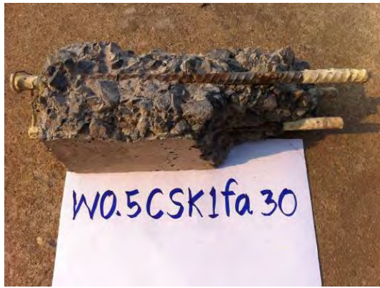
รูปที่ 3.12 ลักษณะเหล็กเสริมที่เกิดสนิมจากการทดสอบชนิดใช้สารยับยั้งชนิดทาที่ผิว
