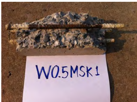
รูปที่ 3.11 ลักษณะเหล็กเสริมที่เกิดสนิมจากการทดสอบชนิดที่ใช้สารยับยั้งชนิดผสมเพิ่มชนิดที่ 1
