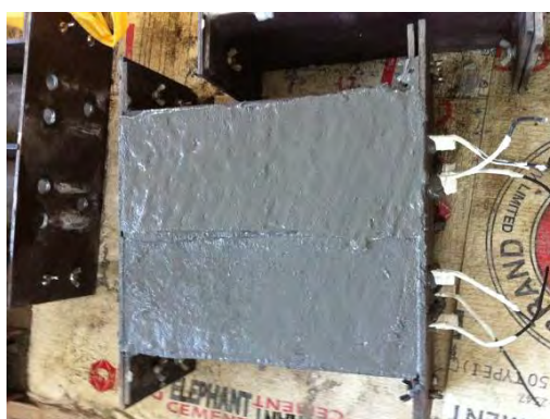
รูปที่ 2.9 ลักษณะของคอนกรีตที่เทเข้าแบบหล่อแล้วทำการตกแต่งผิวหน้าให้ดูเรียบร้อย
