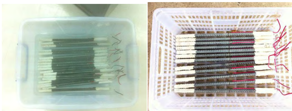
รูปที่ 2.7 ลักษณะเหล็กเสริมที่เคลือบฟอสเฟต
