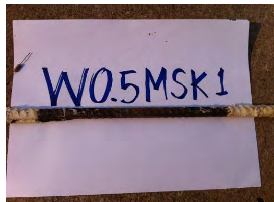
รูปที่ 3.11 ลักษณะเหล็กเสริมที่เกิดสนิมจากการทดสอบชนิดที่ใช้สารยับยั้งชนิดผสมเพิ่มชนิดที่ 1
