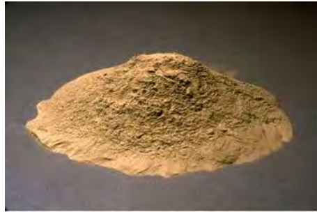
รูปที่ 2.2 แก้วลอยที่เป็นออกไซด์ของซิลิกา และอะลูมินา
