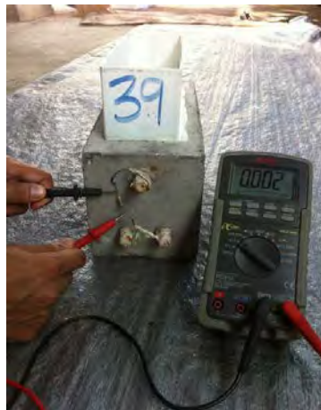
รูปที่ 2.14 การวัดอัตราการเกิดสนิมโดยใช้โวลต์มิเตอร์วัดคร่อมตัวต้านทาน
