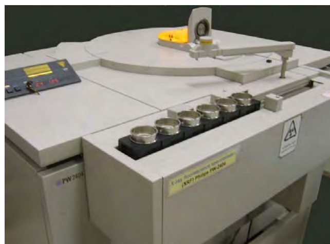
รูปที่ 3.7 เครื่อง XRF สำหรับวิเคราะห์หาองค์ประกอบทางเคมี
