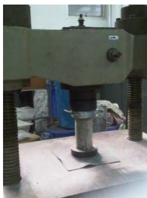
รูปที่ 3.9 การทดสอบกำลังอัดของคอนกรีต
