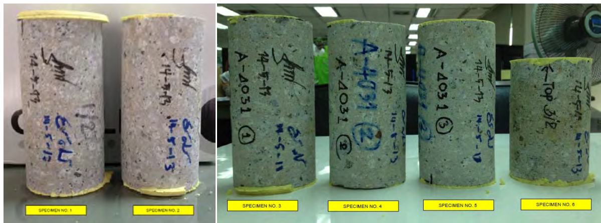
รูปที่ 6.6 ตัวอย่างที่เจาะเก็บจากฐานรากและผ่านการทดสอบกำลังอัดแล้ว
