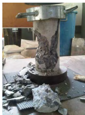
รูปที่ 3.9 การทดสอบกำลังอัดของคอนกรีต
