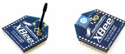
รูปที่ 2.14 รูปสายอากาศแบบ Wire (Whip) และแบบ Chip ตามลำดับ [6]
