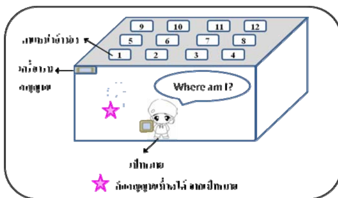
รูปที่ 2.20 ภาพรวมของระบบการหาตำแหน่งโดยเทคโนโลยี RFID บนพื้นฐานวิธีฟิงเกอร์ปริ้นต์ [7]
