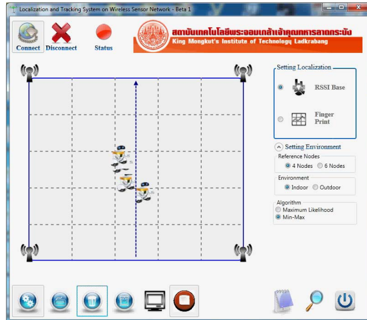
รูปที่ 4.39 การเคลื่อนที่ของวัตถุที่โปรแกรมคำนวณได้ โดยใช้เทคนิค Min-Max ตามแนวตั้งกึ่งกลางของพื้นที่การทดลอง โดยใช้ตัวรับ 4 ตัว
