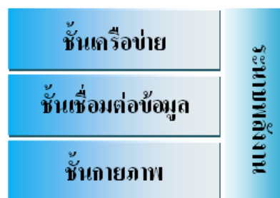
รูปที่ 2.3 ระดับชั้นโปรโตคอลของเครือข่ายสื่อสารไร้สาย [2]
