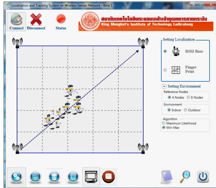
รูปที่ 4.37 การเคลื่อนที่ของวัตถุที่โปรแกรมคำนวณได้ โดยใช้เทคนิค Min-Max ตามแนวมุมด้านล่างซ้ายมือถึงมุมด้านบนขวามือ ของพื้นที่การทดลอง โดยใช้ตัวรับ 4 ตัว
