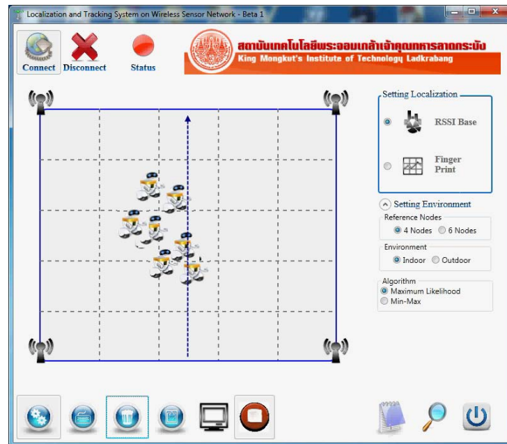
รูปที่ 4.35 การเคลื่อนที่ของวัตถุที่โปรแกรมคำนวณได้ โดยใช้เทคนิค Maximum Likelihood ตามแนวตั้งกึ่งกลางของพื้นที่การทดลอง โดยใช้ตัวรับ 4 ตัว
