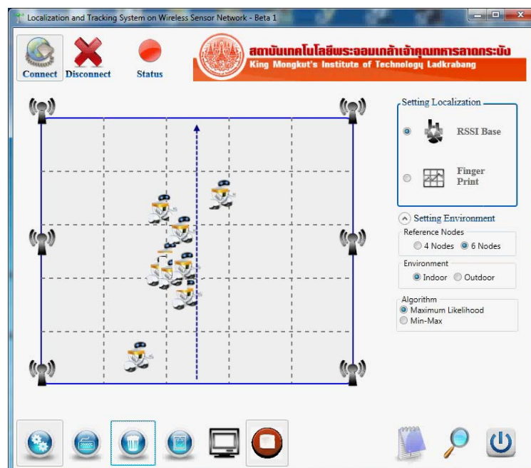
รูปที่ 4.36 การเคลื่อนที่ของวัตถุที่โปรแกรมคำนวณได้ โดยใช้เทคนิค Maximum Likelihood ตามแนวตั้งกึ่งกลางของพื้นที่การทดลอง โดยใช้ตัวรับ 6 ตัว
