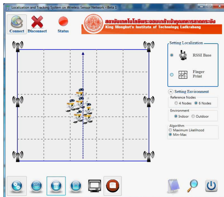
รูปที่ 4.40 การเคลื่อนที่ของวัตถุที่โปรแกรมคำนวณได้ โดยใช้เทคนิค Min-Max ตามแนวตั้งกึ่งกลางของพื้นที่การทดลอง โดยใช้ตัวรับ 6 ตัว
