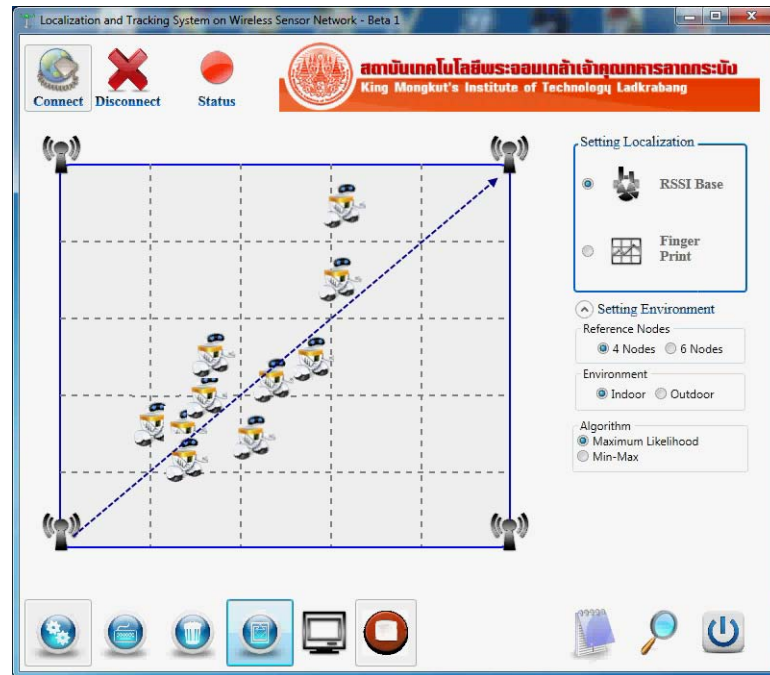
รูปที่ 4.33 การเคลื่อนที่ของวัตถุที่โปรแกรมคำนวณได้ โดยใช้เทคนิค Maximum Likelihood ตามแนว มุมด้านล่างซ้ายมือ ถึง มุมด้านบนขวามือ ของพื้นที่การทดลอง โดยใช้ตัวรับ 4 ตัว
