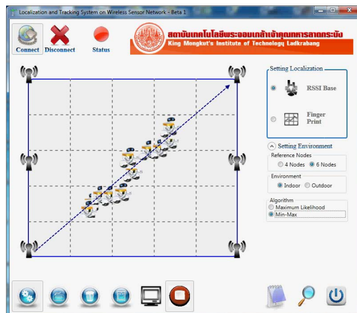
รูปที่ 4.38 การเคลื่อนที่ของวัตถุที่โปรแกรมคำนวณได้ โดยใช้เทคนิค Min-Max ตามแนวมุมด้านล่างซ้ายมือถึงมุมด้านบนขวามือ ของพื้นที่การทดลอง โดยใช้ตัวรับ 6 ตัว
