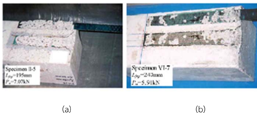
รูปที่ 3 การพื้ติที่บริเวณรอยต่อในตัวอย่างทดสอบแบบ Single-lap Shear Test [9]
