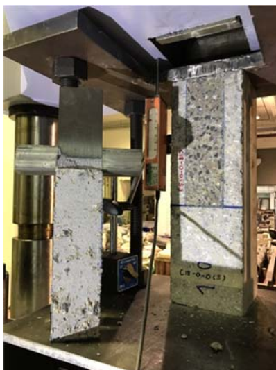
รูปที่ 46 ตัวอย่างลักษณะการพิบัติที่เกิดขึ้นในรอยต่อ
