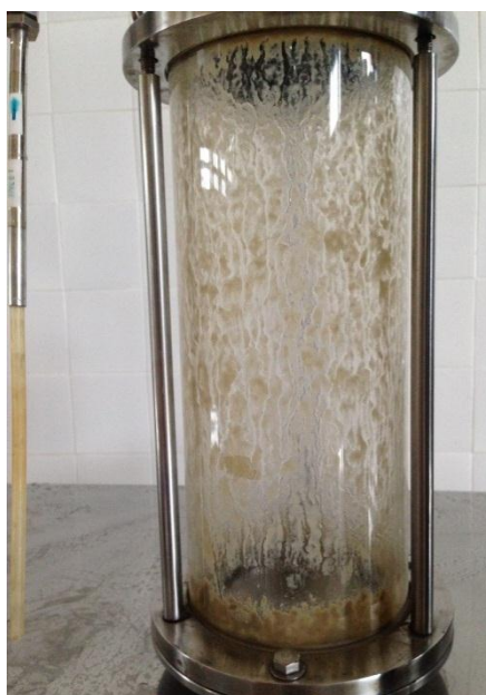
ภาพผนวกที่ 9.1 การเกาะติดของสารสกัดที่บริเวณผนังของห้องระเหยของเครื่องระเหยแบบสุญญากาศ
