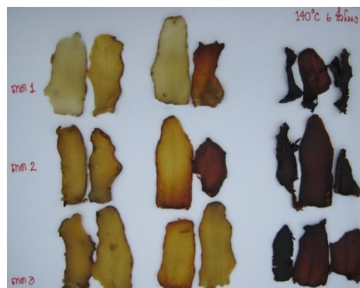
ภาพผนวกที่ 3.7 ตัวอย่างแก่นตะวันที่ทำแห้งด้วยไอน้ำร้อนยวดยิ่งที่อุณหภูมิ 140 °C เป็นระยะเวลา 2, 4 และ 6 ชั่วโมง ณ บริเวณต่าง ๆ
