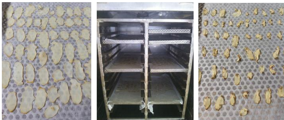
ภาพผนวกที่ 2.2 การอบแห้งตัวอย่างแก๊สวันแบบชั้นบางในระดับห้องปฏิบัติการ
