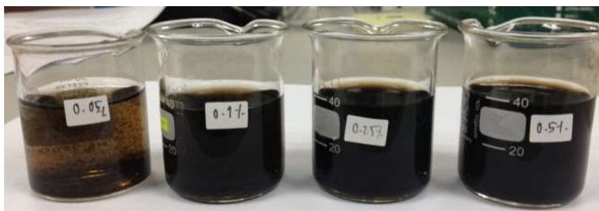
รูปที่ 5 ความสามารถในการ adsorb ของ GO monolayer บน primer ที่เวลา 18 ชั่วโมง ที่ความเข้มข้น GO 0.05, 0.1, 0.25 และ 0.5%wt
