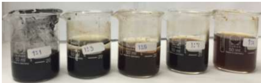
รูปที่ 1 ลักษณะทางกายภาพและความสามารถในการกระจายตัวของแกรฟีนออกไซด์ ที่สังเคราะห์ด้วย สัดส่วนโดยน้ำหนักของแกรฟไฟท์ G : \text{KMnO}_4 , 1 : 1,3,5,7,9 ตามลำดับ
