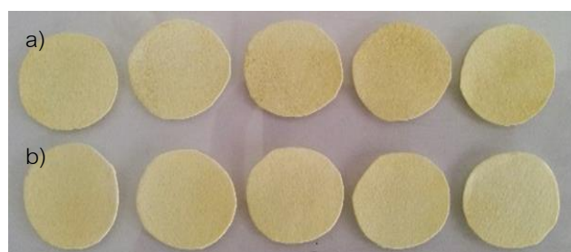
รูปที่ 14 กระดาษกรองที่ถูกเตรียม (ทำการทดลอง 5 ซ้ำ) ด้วยวิธีการจุ่มกระดาษกรองในสารผสม CdSAg-MAA QDs/CS (a) และการแบบฉีดพ่น CS ก่อนจุ่มในสารคอลลอยด์ CdSAg-MAA QDs (b)
