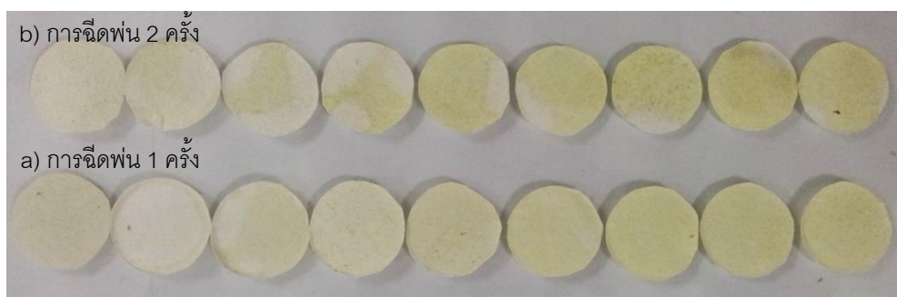
รูปที่ 18 กระจกกรองที่ถูกเตรียมด้วยวิธีการการฟอสฟอเรสเซนซ์ของ CdSAg-MAA QDs 2 ครั้ง (a) การฉีดพ่น 1 ครั้ง (b) เมื่อทำปฏิกิริยากับ H_2S ที่ความเข้มข้นแตกต่างกัน (20-xxx \mu M )
