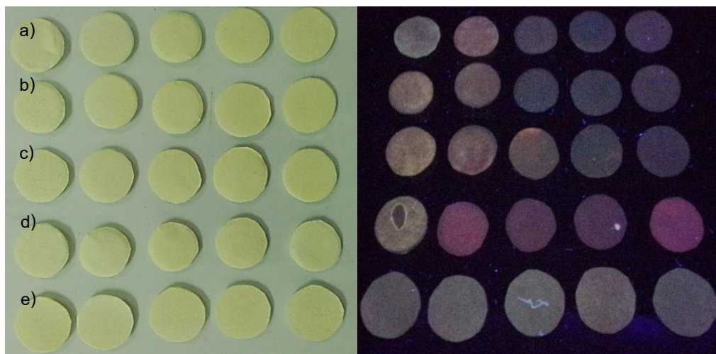
รูปที่ 24 การประยุกต์ใช้ CdSAg-MAA QDs/CS ที่เคลือบบนกระดาษกรองในการวิเคราะห์แก๊ส \text{H}_2\text{S} ในตัวอย่างน้ำ
