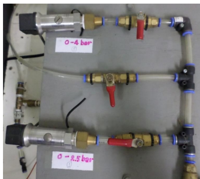
รูปที่ 13 ตัวแปลงสัญญาณความดันหรือทรานสดิวเซอร์วัดความดัน
