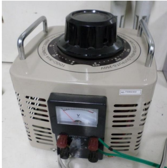
รูปที่ 16 หม้อแปลงไฟฟ้าแบบปรับค่าแรงดันไฟฟ้าได้
