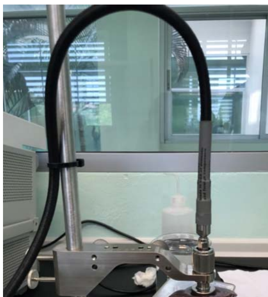
รูปที่ 4.2 หัววัดแบบ Coaxial Probe รุ่น N1500A
