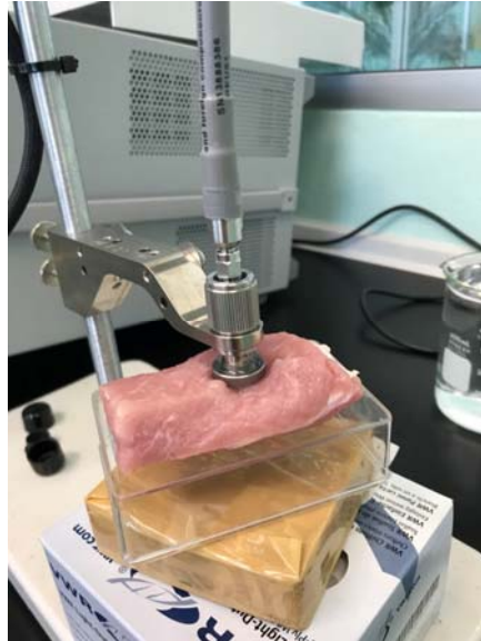
รูปที่ 4.4 การวัดค่าคุณสมบัติไดอิเล็กตริกของเนื้อเยื่อส่วนผิวหนังด้วยเครื่อง Network analyzer
