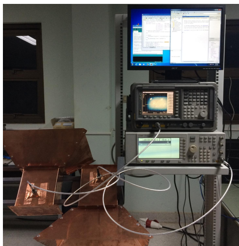
ภาพที่ 2.13: รูปแบบระบบการรับส่งสัญญาณคลื่นแม่เหล็กไฟฟ้าและโปรแกรมที่ใช้ในการควบคุมการทำงาน
