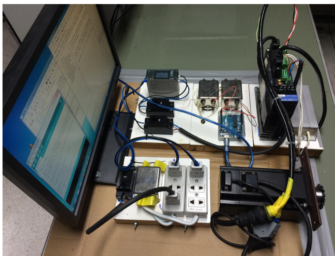
ภาพที่ 2.11: วงจรการต่อสัญญาณ command pulse input ไปยัง Servo amplifier เพื่อบังคับทิศทาง การหมุนของมอเตอร์
