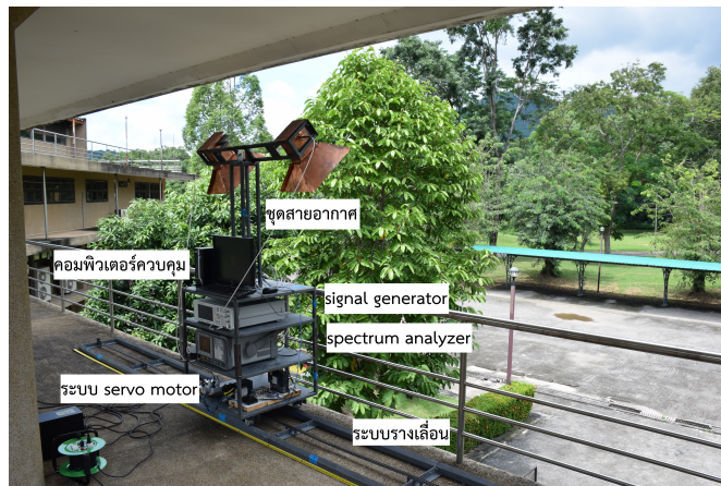
ภาพที่ 3.5: ภาพแสดงระบบการทำงานและอุปกรณ์ส่วนประกอบ, [15]
