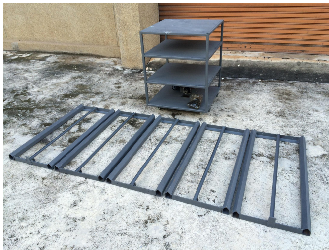
ภาพที่ 2.3: การจัดสร้างชุดอุปกรณ์ระบบรางเลื่อนประกอบไปด้วยระบบรางรองรับจำนวน 5 ชั้นและชั้นโครงสร้างสำหรับจัดวางเครื่องมือวัด
