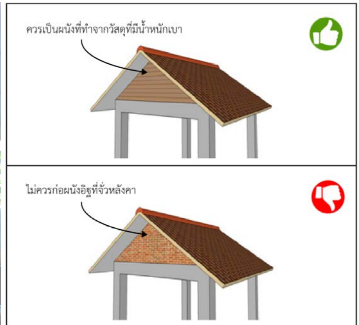
รูปที่ 4. ลักษณะความเสียหายของอาคารที่ได้รับความเสียหายประเภทที่ 1 โดยผนังคอนกรีตบล็อกพังถล่ม (Out-of-plane failure) และแนวทางการซ่อมแซมเบื้องต้น
