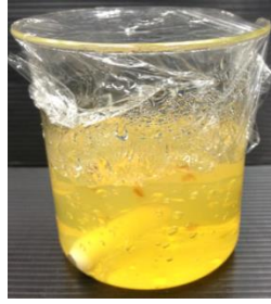
ภาพที่ 54 ลักษณะสารละลายโคโตซานหลังเติมสารละลาย GA
