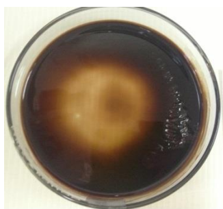
ภาพที่ 50 ลักษณะเยื่อเลือกผ่านของ CS-8SSA ที่ทำการอบแห้งที่ 60 องศาเซลเซียส เมื่อเวลาผ่านไป 14 วัน
