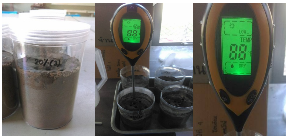
รูปที่ 4.7 วัดความชื้นสัมพัทธ์ของดิน เมื่อความชื้นสัมพัทธ์ของดินเท่ากับ 20 % (มีปริมาณน้ำเท่ากับ 100 กรัม)
