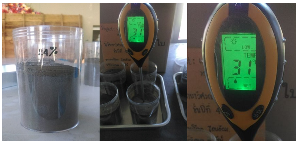
รูปที่ 4.11 วัดความชื้นสัมพัทธ์ของดิน เมื่อความชื้นสัมพัทธ์ของดินเท่ากับ 24 % (มีปริมาณน้ำเท่ากับ 120 กรัม)
