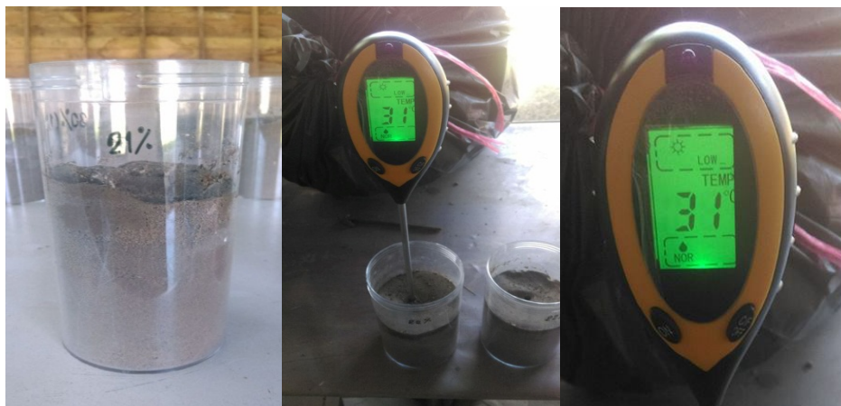
รูปที่ 4.8 วัดความชื้นสัมพัทธ์ของดิน เมื่อความชื้นสัมพัทธ์ของดินเท่ากับ 21 % (มีปริมาณน้ำเท่ากับ 105 กรัม)
