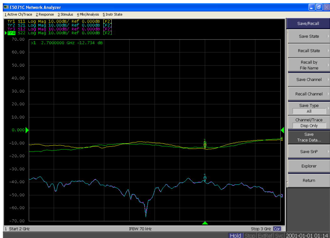
รูปที่ 4.4 ผลการทดสอบพารามิเตอร์ S ของเซ็นเซอร์เมื่อวางห่างจากสายอากาศของเครื่องอ่านข้อมูล ระยะทาง เท่ากับ 10 เซนติเมตร
