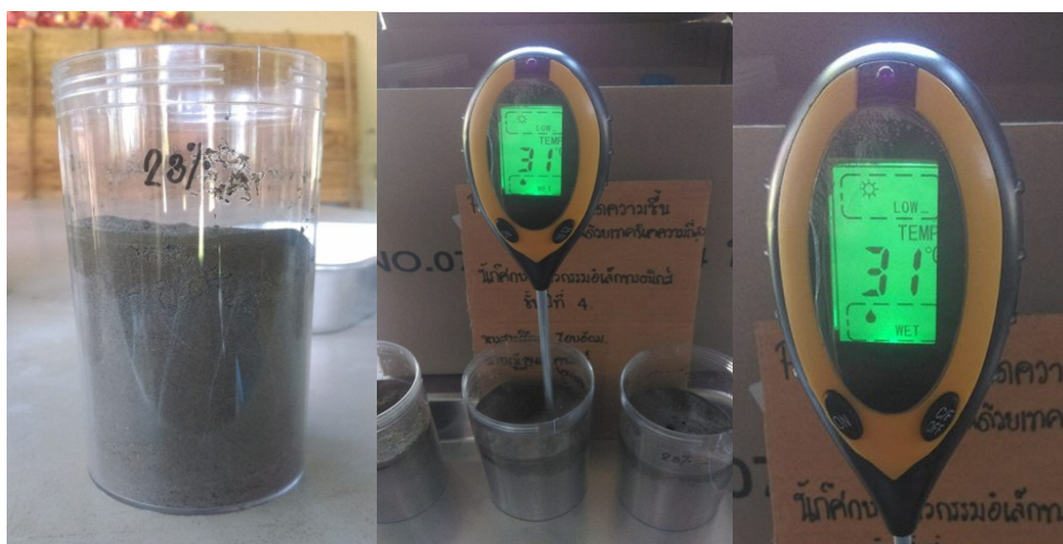
รูปที่ 4.10 วัดความชื้นสัมพัทธ์ของดิน เมื่อความชื้นสัมพัทธ์ของดินเท่ากับ 23 % (มีปริมาณน้ำเท่ากับ 115 กรัม)
