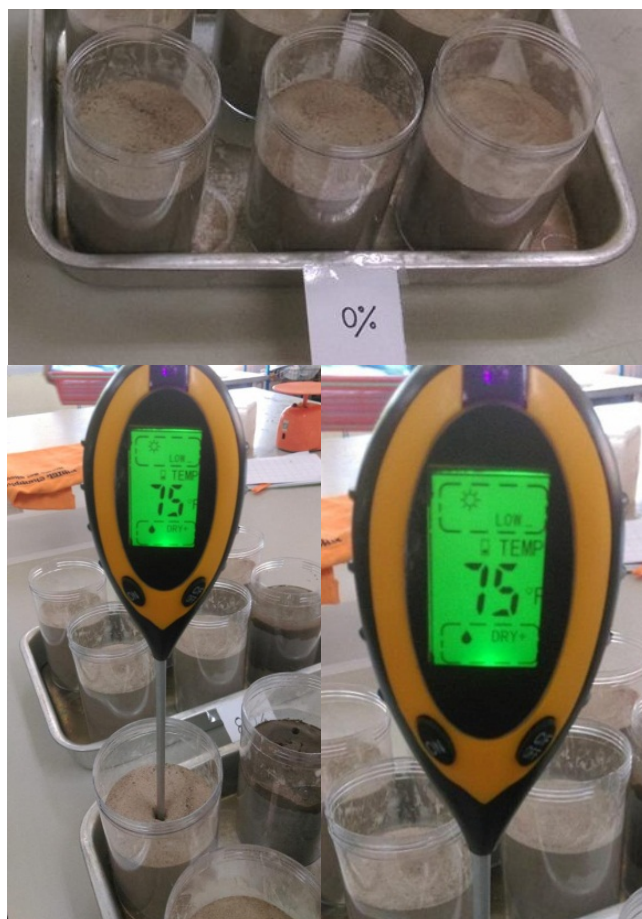
รูปที่ 4.6 วัดความชื้นสัมพัทธ์ของดิน เมื่อความชื้นสัมพัทธ์ของดินเท่ากับ 0 %
