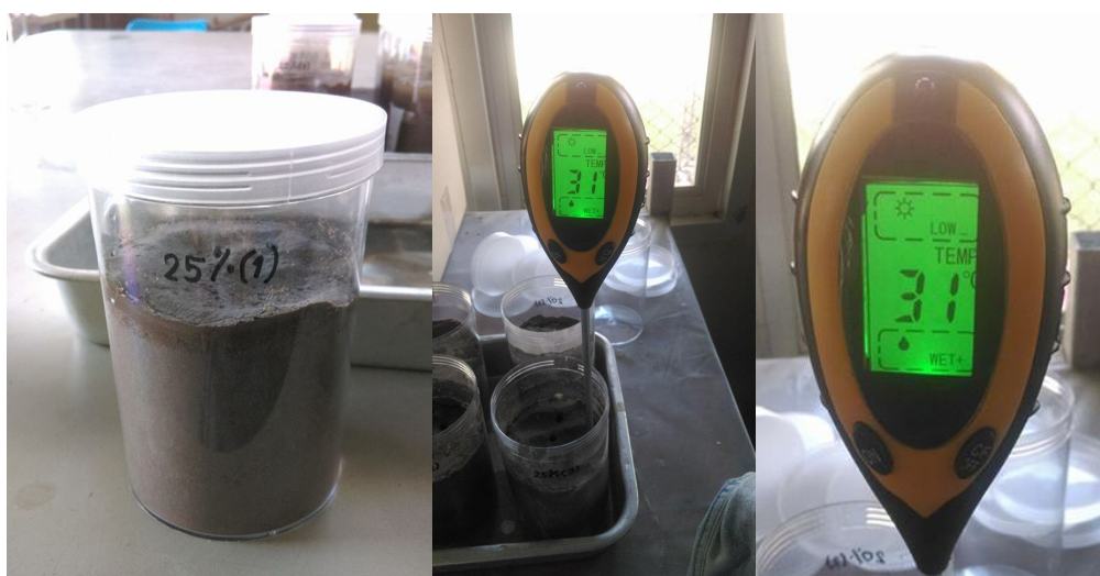
รูปที่ 4.12 วัดความชื้นสัมพัทธ์ของดิน เมื่อความชื้นสัมพัทธ์ของดินเท่ากับ 25 % (มีปริมาณน้ำเท่ากับ 125 กรัม)
