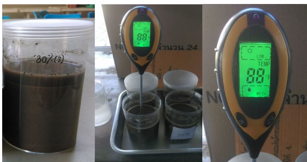
รูปที่ 4.13 วัดความชื้นสัมพัทธ์ของดิน เมื่อความชื้นสัมพัทธ์ของดินเท่ากับ 30 % (มีปริมาณน้ำเท่ากับ 150 กรัม)
