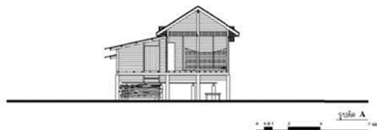
ภาพที่ 3.17 แสดงรูปตัดของเรือนชุมชนคูเต่า อ.หาดใหญ่และอ.บางกล่ำ ในพื้นที่ต่อเนื่องกัน จ.สงขลา
