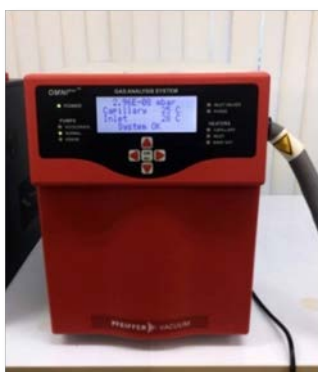
รูปที่ 22 เครื่อง Mass spectrometer วิเคราะห์องค์ประกอบของก๊าซภายในระบบ
