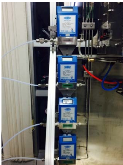
รูปที่ 19 แผงควบคุม Mass flow meter สำหรับการควบคุมอัตราการไหล
