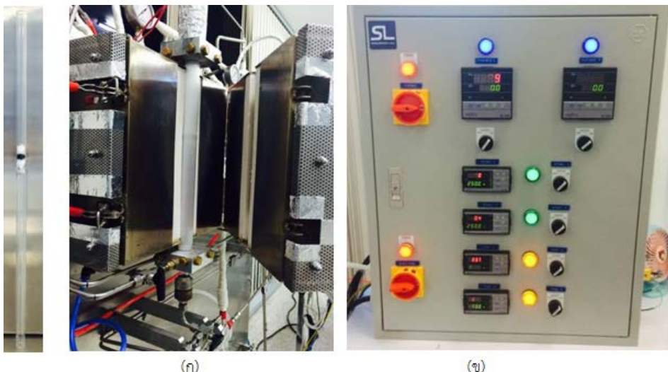
รูปที่ 21 (ก) เครื่องปฏิกรณ์แบบเบตต์นิ่งภายในบรรจุตัวเร่งปฏิกิริยาโลหะออกไซด์ และ (ข) ชุดอุปกรณ์ให้ความร้อนและควบคุมอุณหภูมิของเตาเผา
