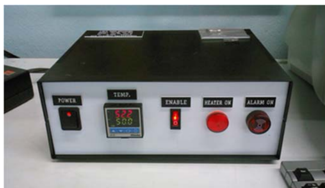
รูปที่ 4.3 อุปกรณ์ควบคุมอุณหภูมิ
