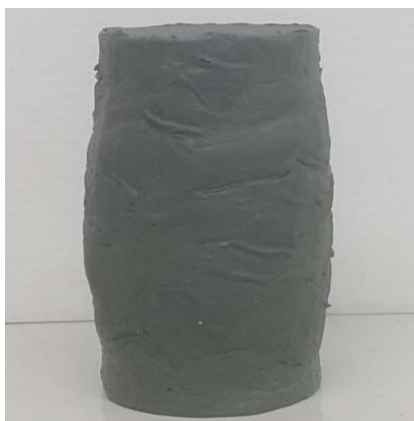
(ก) การวิบัติหลังการเหนียวที่ อัตราความเครียดต่ำ
