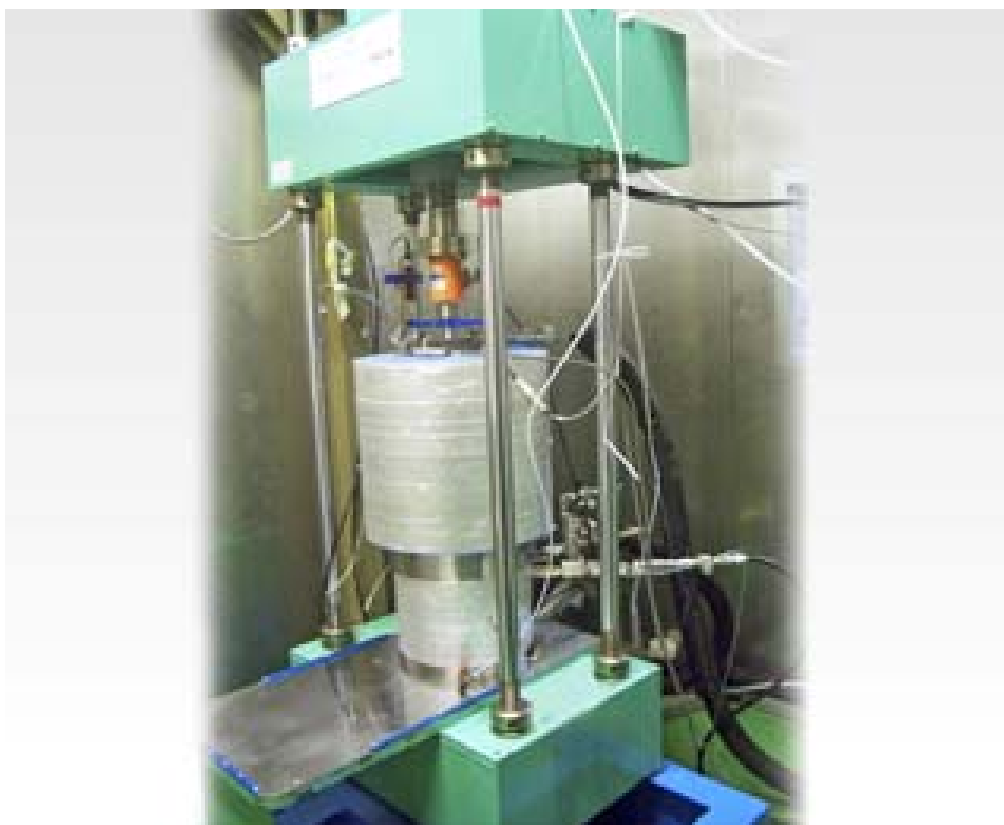
รูปที่ 2.60 เครื่องทดสอบสามแกนสำหรับอุณหภูมิต่ำของบริษัท มารูอิ จำกัด
