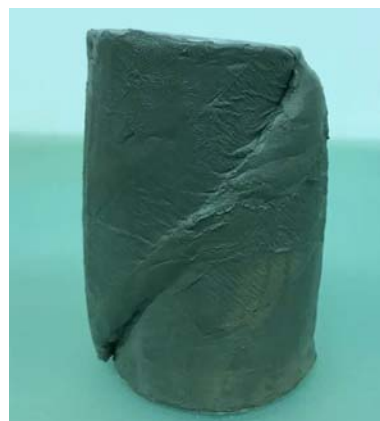
(ข) การวิบัติหลังการเหนียวที่ อัตราความเครียดต่ำ
