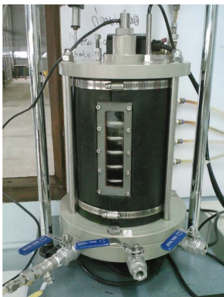
รูปที่ 4.2 เซลล์ทดสอบแรงอัดสามแกนที่สามารถควบคุมอุณหภูมิ
