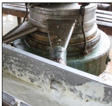
รูปที่ 1 แสดงตัวอย่างปัญหาการเกาะติดของน้ำยางในภาชนะรองรับและในโรงงานอุตสาหกรรม
