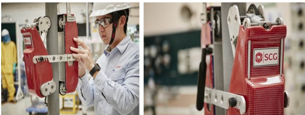
รูปที่ 2.6 Carburization Inspection Robot
